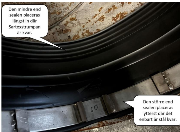
Figur 8:2 Notera storlek på end seals. Den mindre ska sitta längst in.
