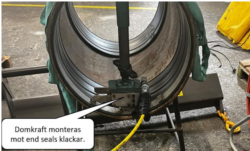
Figur 8:3 Domkraft med stag monterad.
