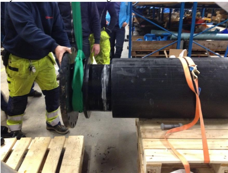
Figur 7:3 Flänsände förs in i PE-rör.
