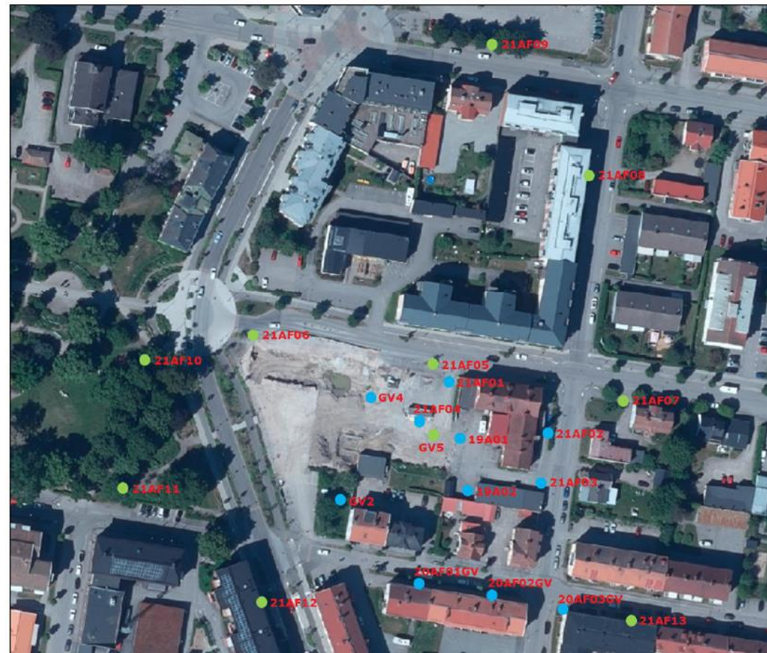
Figur 1. Utdrag ur Lantmäteriets ortofoto över Katrineholm med provtagningspunkter. © Lantmäteriet. Gröna prickar är installerade grundvattenrör i föreliggande undersökning och blå prickar är tidigare installerade grundvattenrör.
