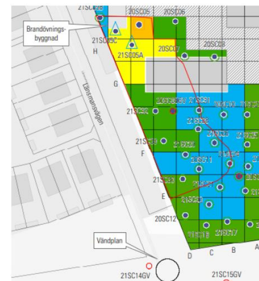
Figur 8 – Förklassificering PFOS/PFAS förorenade massor. Röda linjen visar lerans uppskattade utbredning på fastigheten.
