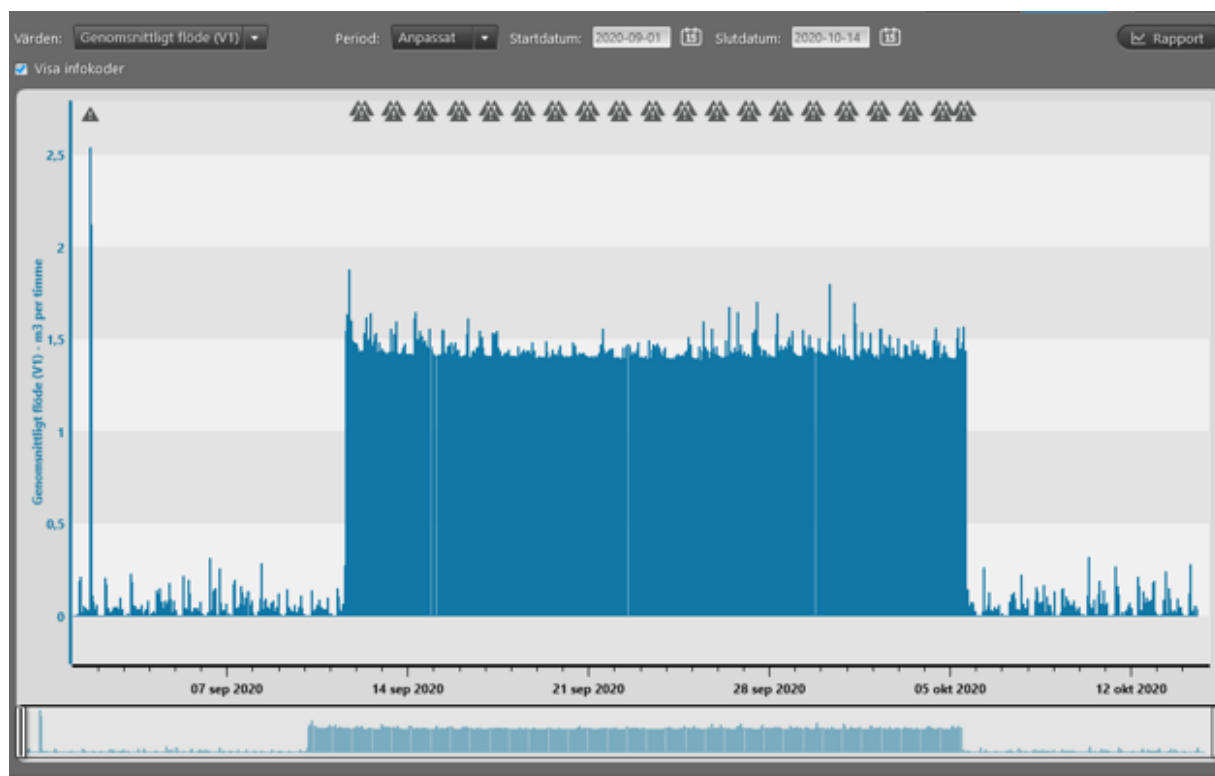
Figur 1. Förbrukning pga. läckage
